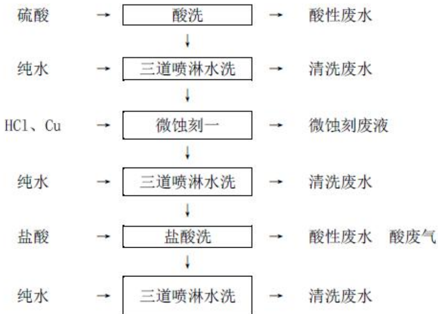
图 2-6 苏虹中路 468 号厂区化学镀前处理②工艺过程示意图
