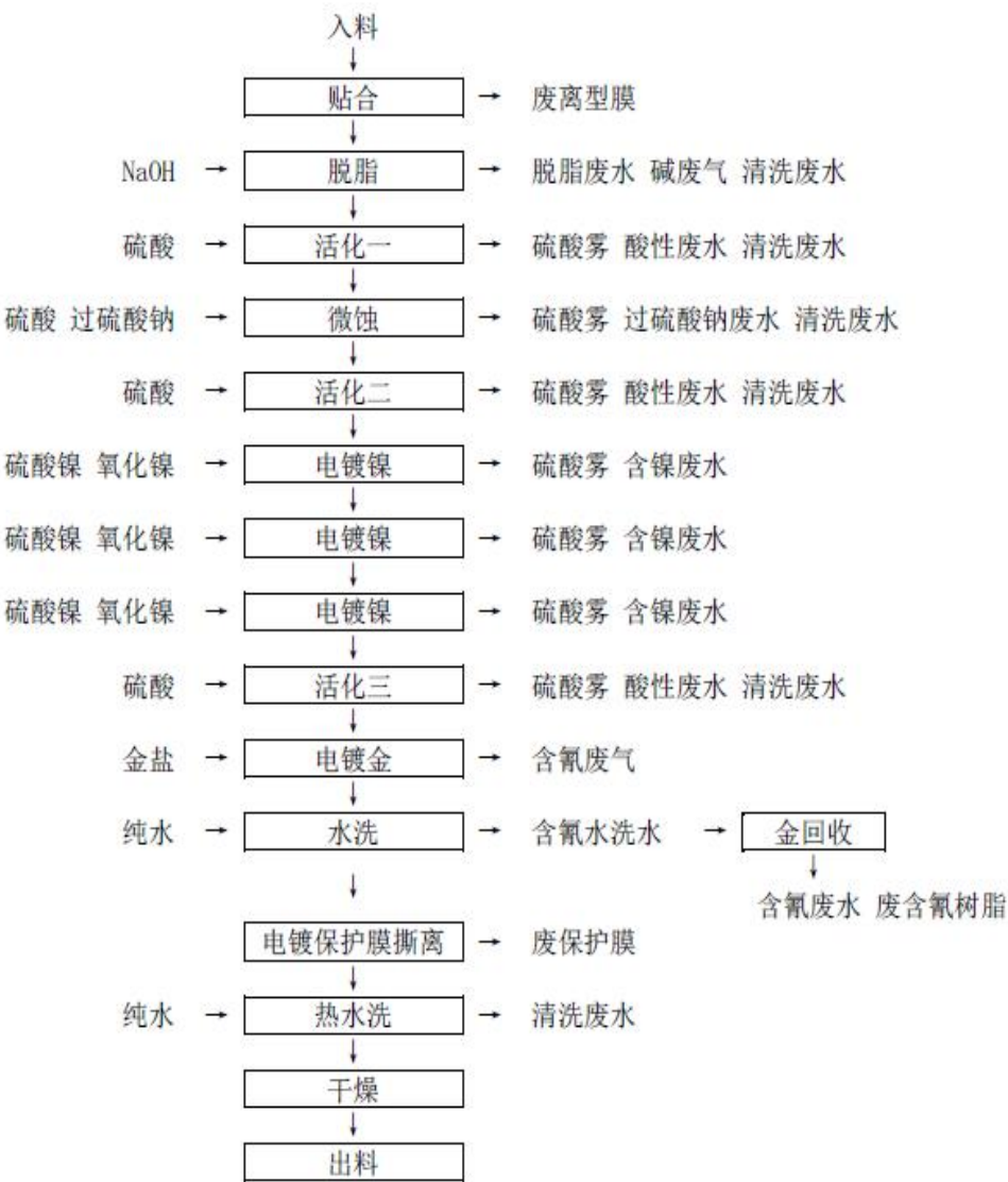
图 2-4 苏虹中路 468 号厂区电镀镍金工艺流程及节点产污环节图
